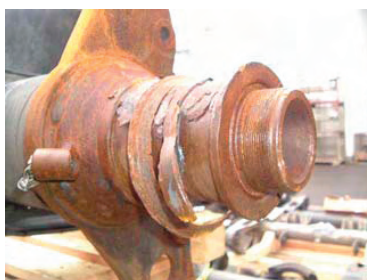
Bild 11 Om typskylt saknas – fotografera serienumret från axeländan.
