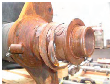
Kuva 11 Tyypikilven puuttuessa – kuvaa sarjanumero akselitapista.
